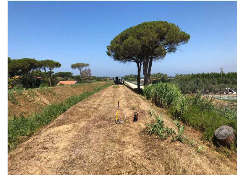
Stendimento di sismica di tipo - MASW
