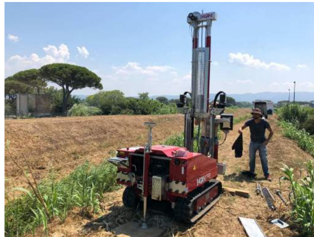
Postazione prova penetrometrica dinamica - DPSH 2
