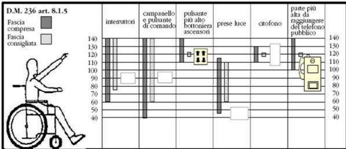
Si ricorda che la fascia di accessibilità compresa fra i 40 e 140cm è riferita alle apparecchiature normalmente utilizzate e manovrate dall'utente fruitore del locale o degli spazi e non si riferisce ai componenti installati in funzione di scelte progettuali che migliorano la sicurezza e l'economia dell'impianto come ad esempio:
