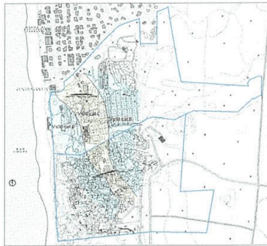
**Isovelocità delle Vs30**
