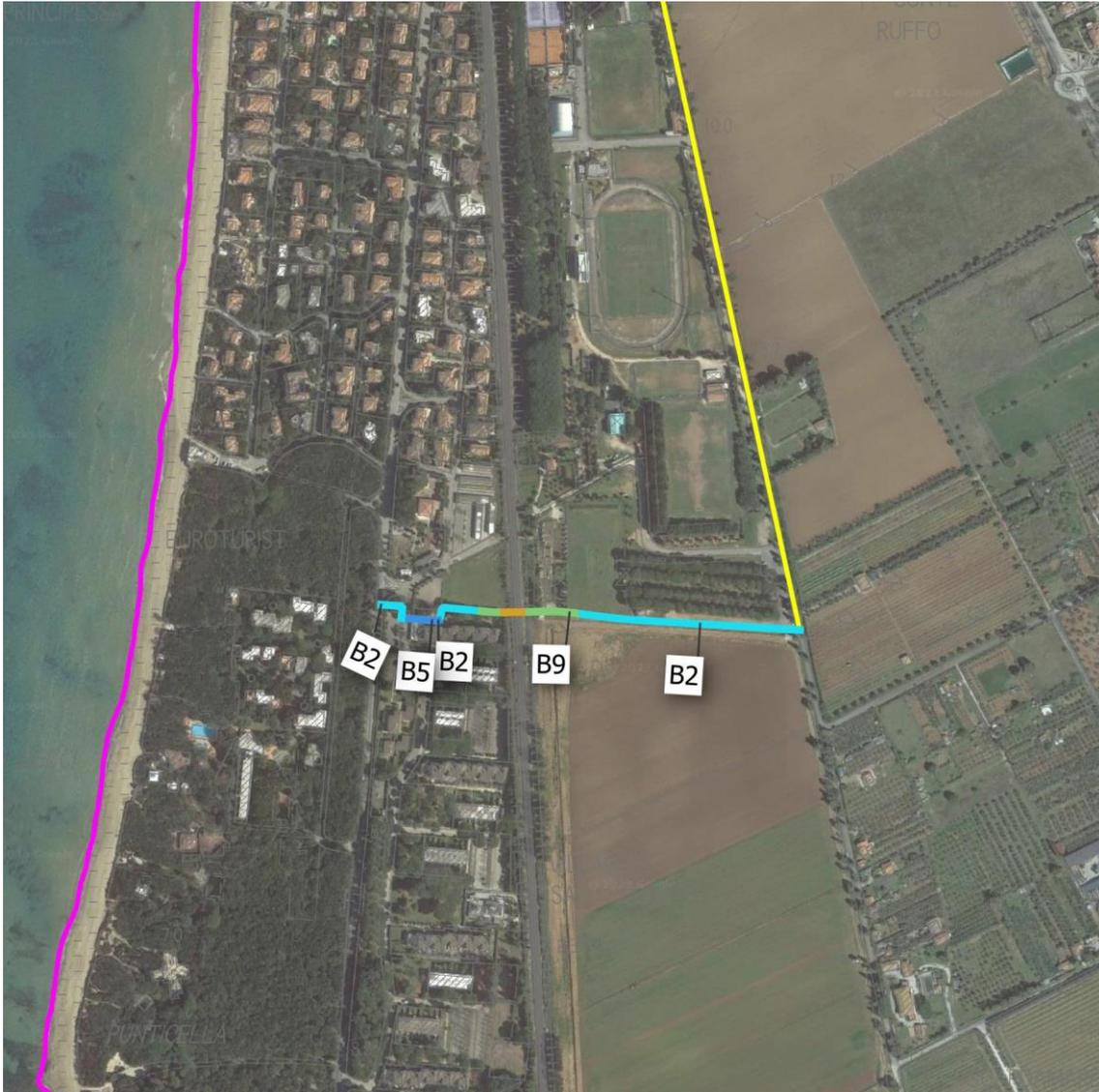
Il progetto continua con la realizzazione di ciclovia su rampa in scavo con muri controterra (tratti 30 e 32, sezione tipo B9) di pendenza adeguata che permettono di raggiungere il sottopasso di progetto.
