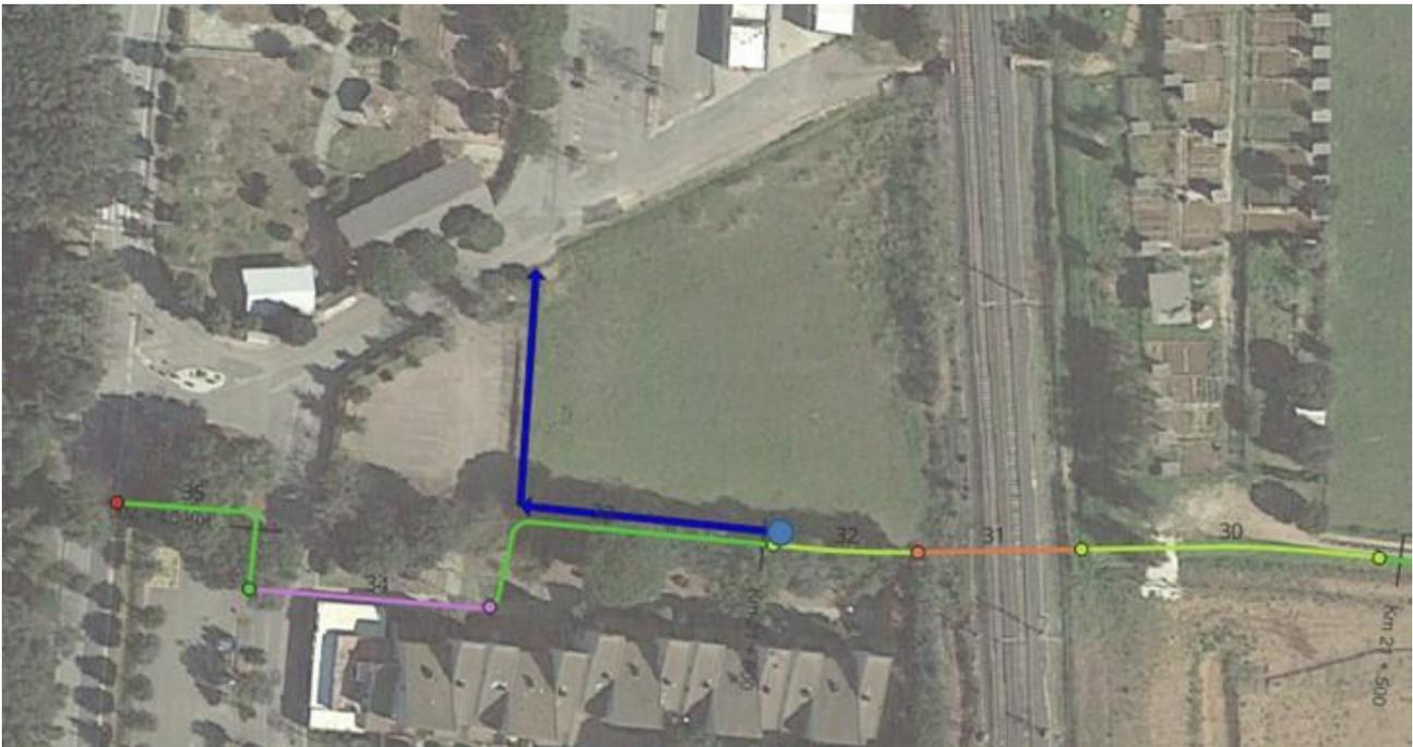
*Schema di evacuazione delle acque meteoriche insistenti sul sottopasso ferroviario*
