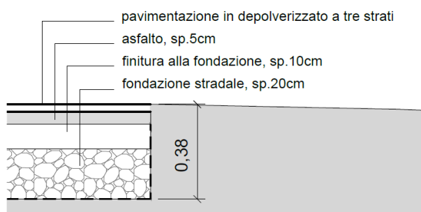
Figura 30 – Dettaglio pacchetto sezioni tipo B1 e B10
