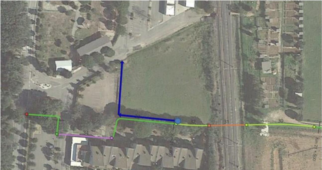
Figura 30 – Schema di evacuazione delle acque meteoriche insistenti sul sottopasso ferroviario
