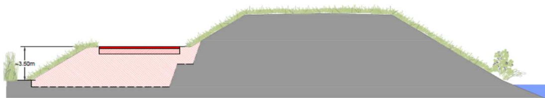
F4 - REALIZZAZIONE NUOVA CICLOVIA / RAMPA SU RILEVATO
