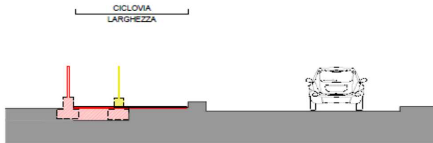
E4 - ALLARGAMENTO DI PERCORSO CICLABILE ASFALTATO LATO CAMPAGNA CON RECINZIONE IN PRESENZA DI CORDOLO
