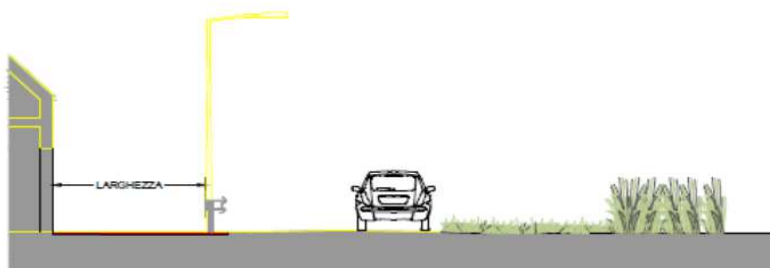
G26 - PERCORSO CICLOVIA CON TRASLAZIONE MARCIAPIEDE E CON CORDOLO
