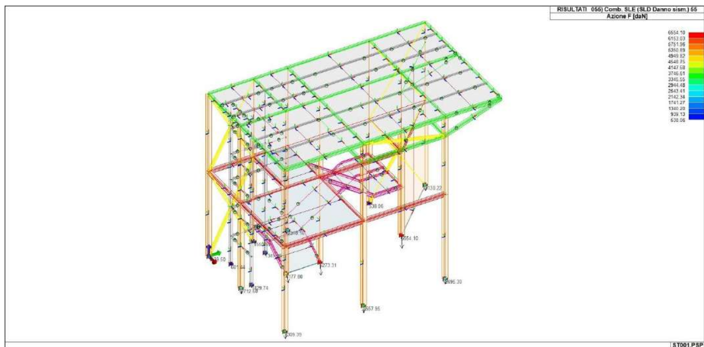
42_RIS_REAZIONI_055_Comb SLE SLD Danno sism 55
