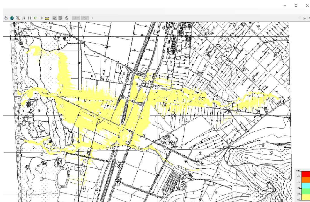
Figura 53 – Risultati modellazione idraulica sistema Fosso della Carestia – Fosso dell'Acquacalda per Tr 200 anni – velocità di propagazione delle piene
