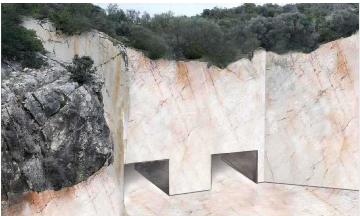
esemplificazione dell'accesso alla cava in sotterraneo
